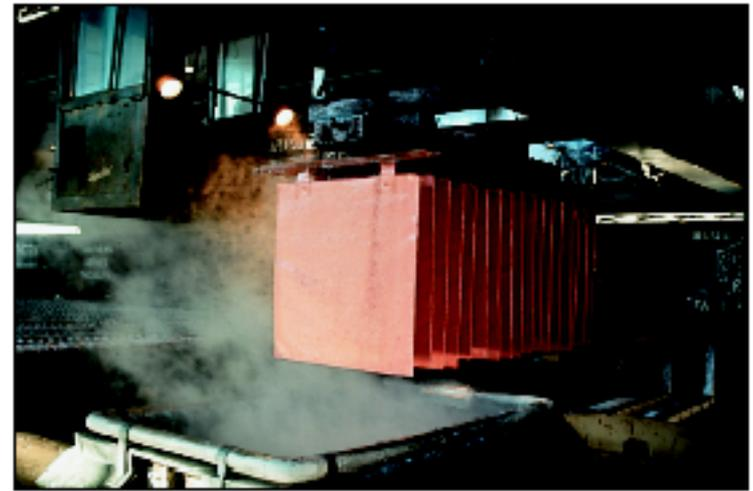
O cobre impuro é oxidado a  $\text{Cu}^{2+}$  no anodo. Os íons  $\text{Cu}^{2+}$  aquosos são reduzidos a Cu metálico no catodo.
