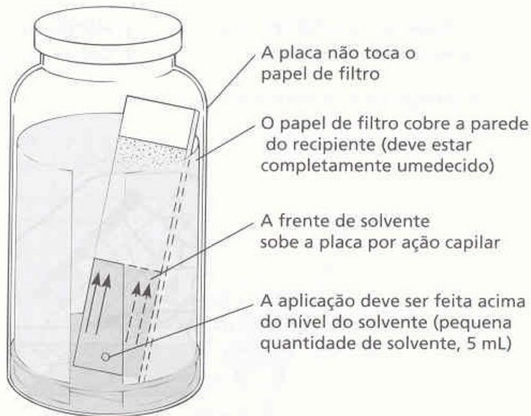
Figura 20.4 Câmara de desenvolvimento com uma placa de cromatografia em camada fina.
